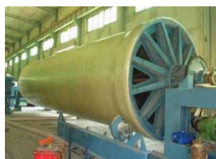
Изготовление внутреннего слоя
